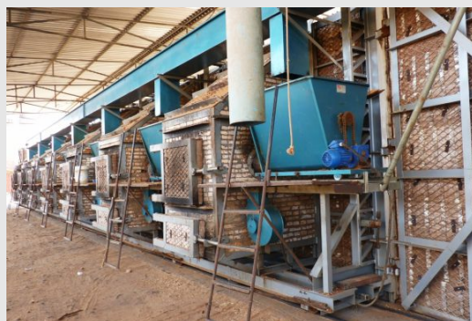
SISTEMA DE ALIMENTAÇÃO DE CAVACO/LENHA PICADA EM FORNO MÓVEL
