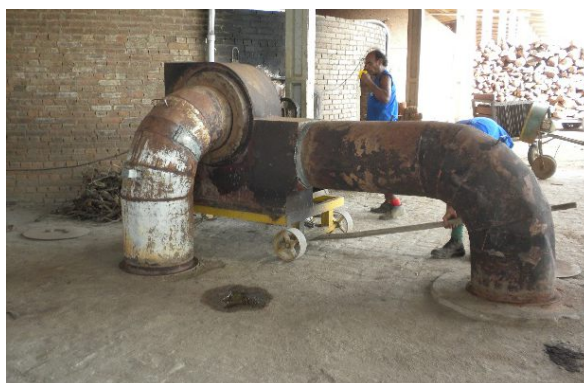
DUTOS AUXILIARES DE RECUPERAÇÃO DE CALOR E INTERLIGAÇÃO COM CANAIS SUBTERRÂNEOS EM FORNO ABÓBADA (DURANTE A QUEIMA)
