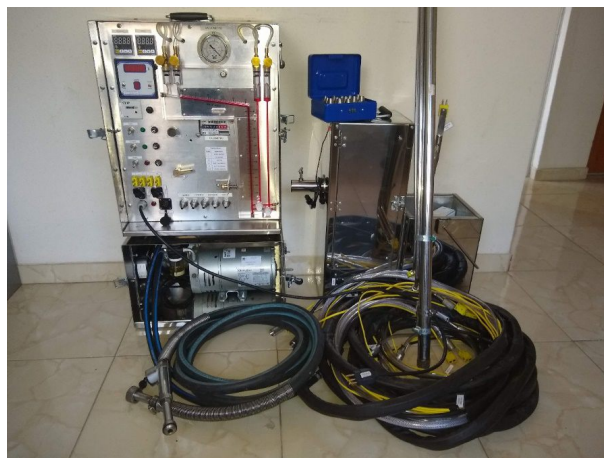
COLETOR ISOCINÉTICO DE POLUENTES ATMOSFÉRICOS (CIPA). FONTE: RMV SERVIÇOS.
