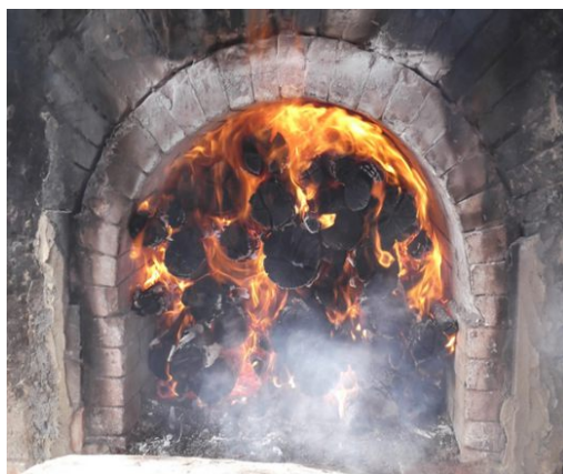
FORNALHA COM EXCESSO DE LENHA E POUCA ENTRADA DE AR
