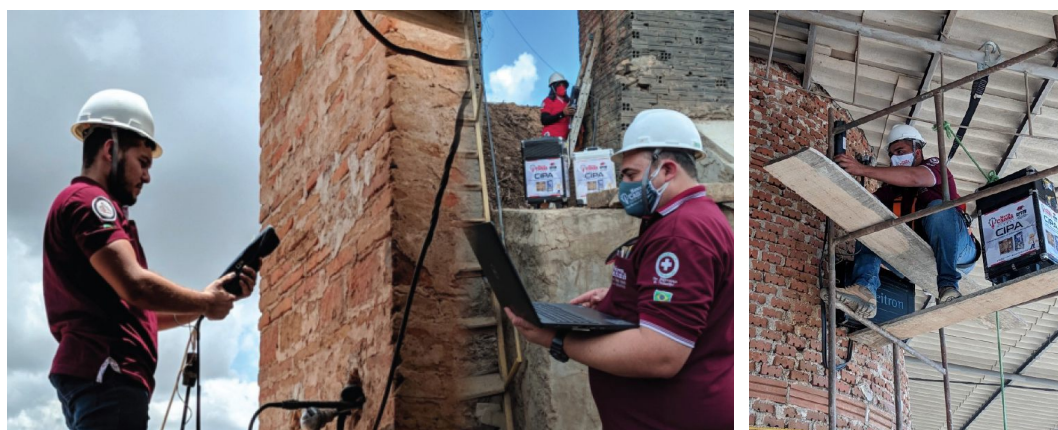
TÉCNICOS REALIZANDO AMOSTRAGEM EM CHAMINÉ. FONTE: CONSULTORIA TECNOLÓGICA EM CERÂMICA NOVA CANAÃ LTDA
