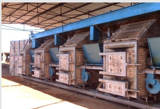
SISTEMA DE ALIMENTAÇÃO DE CAVACO/LENHA PICADA EM FORNO MÓVEL
