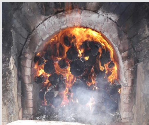
FORNALHA COM EXCESSO DE LENHA E POUCA ENTRADA DE AR
