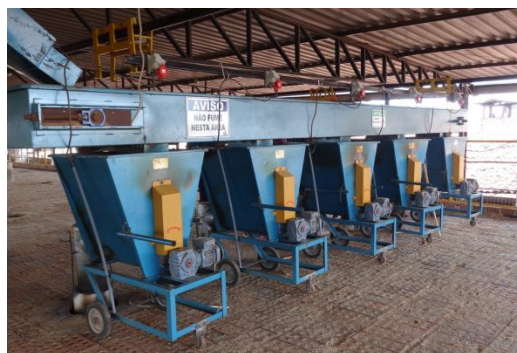
SISTEMA DE CAIXAS ALIMENTADORAS DE LENHA PICADA EM FORNO CÂMARA
