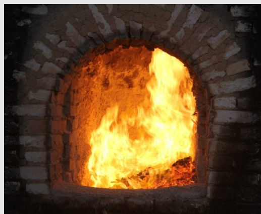
FORNALHA COM LENHA PICADA EM VOLUMES DE AR EQUILIBRADOS E ESTÁVEIS
