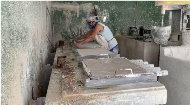
Figura 10 – Produção manual de placas de gesso.
