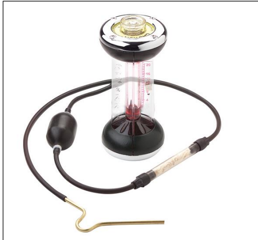
Figura 10. Kit Bacharach para a medição de teor de dióxido de carbono ( \text{CO}_2 ) ou de oxigênio ( \text{O}_2 ) em gases de combustão.
