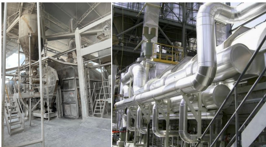
Figura 4. Fornos tipo marmita rotativa revestidos com chapa de aço. Fonte: própria (à esquerda) e SINDUSGESSO (2023) (à direita).
