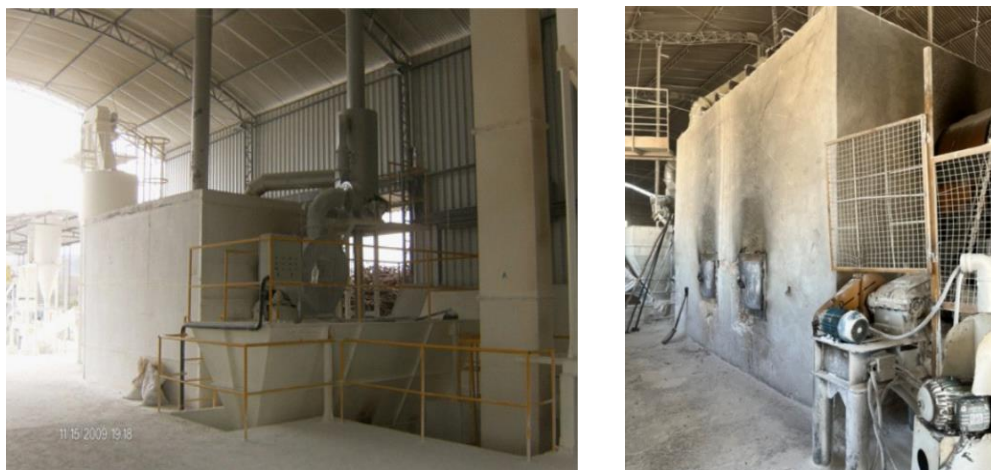
Figura 3. Fornos barriga quente. Fonte: Peres in PROJETEC (2010) (à esquerda) e própria (à direita).
