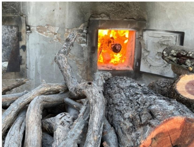
Figura 11. Queima de lenha em toras sem controle de alimentação e combustão.
