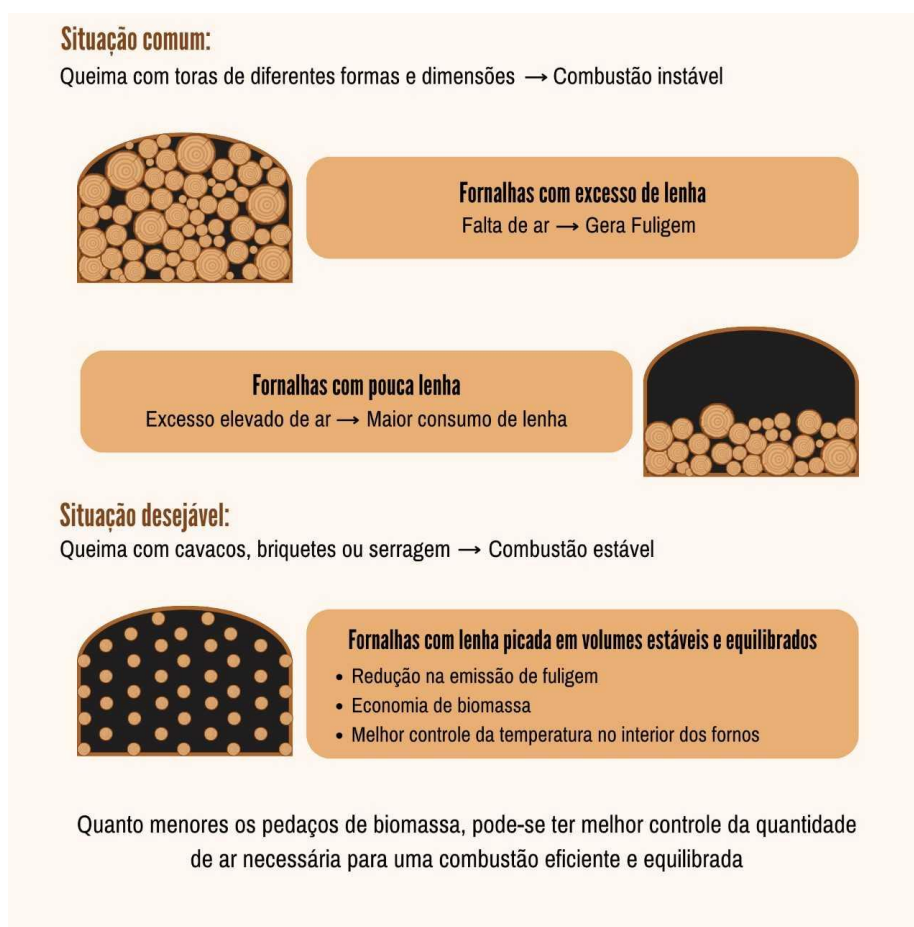
Figura 5. Representação gráfica de fornalhas: i) com excesso de lenha em toras e pouco ar; ii) com pouca lenha e muito ar; iii) com pedaços menores de biomassa numa situação equilibrada com a quantidade de ar de combustão.
