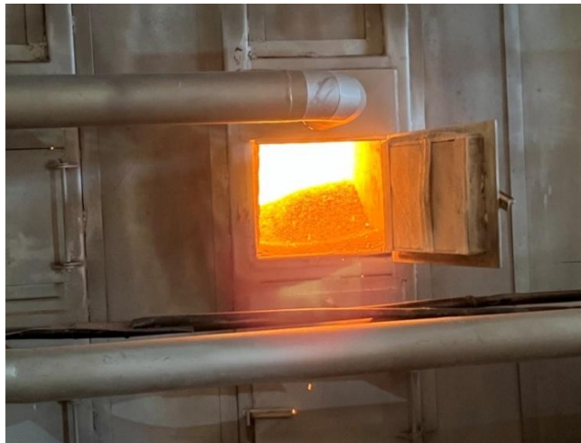
Figura 7. Vista de fornalha com queima de lenha picada.
