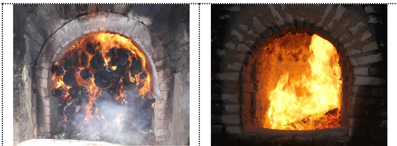
Figura 4. Fornalha com excesso de lenha e pouco ar de combustão (à esquerda) e fornalha com lenha em quantidade adequada aos volumes de ar (à direita).
