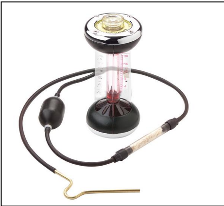
Figura 2. Kit Bacharach para medição de teor de dióxido de carbono (CO 2 ) ou de oxigênio (O 2 ) em gases de combustão.
