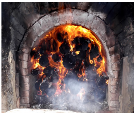
Figura 3. Fornalha com excesso de lenha e pouco ar de combustão (à esquerda). Fornalha com lenha em quantidade adequada aos volumes de ar (à direita).
