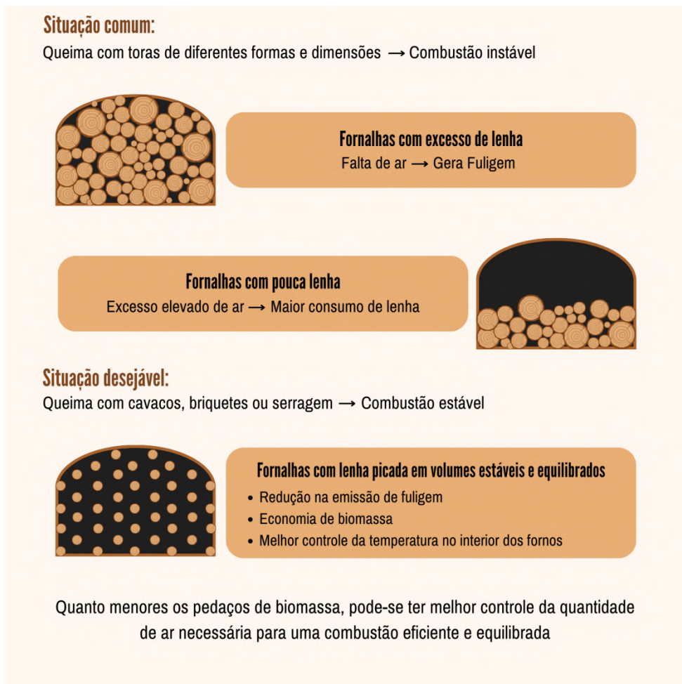
Figura 4. Representação gráfica de fornalhas com excesso de lenha em toras, com pouca lenha e muito ar, e com pedaços pequenos de biomassa numa situação ajustada de ar de combustão.
