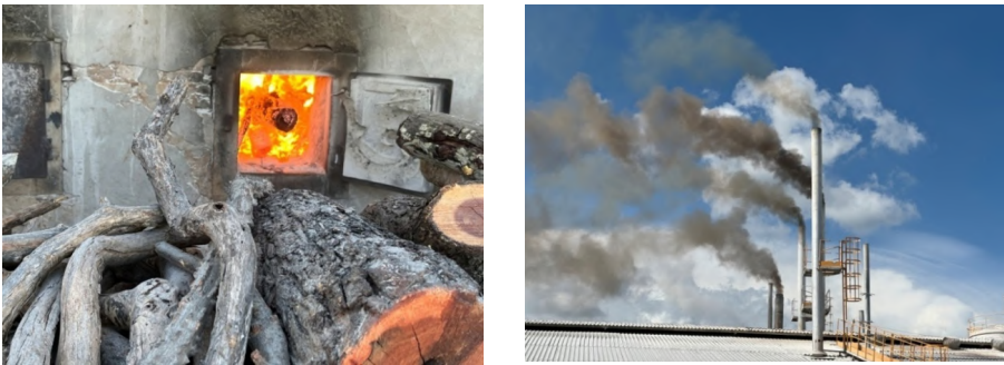
Figura 4. Queima de lenha em toras sem controle de alimentação e da combustão (à esquerda). Emissões de fuligem por má combustão (à direita).
