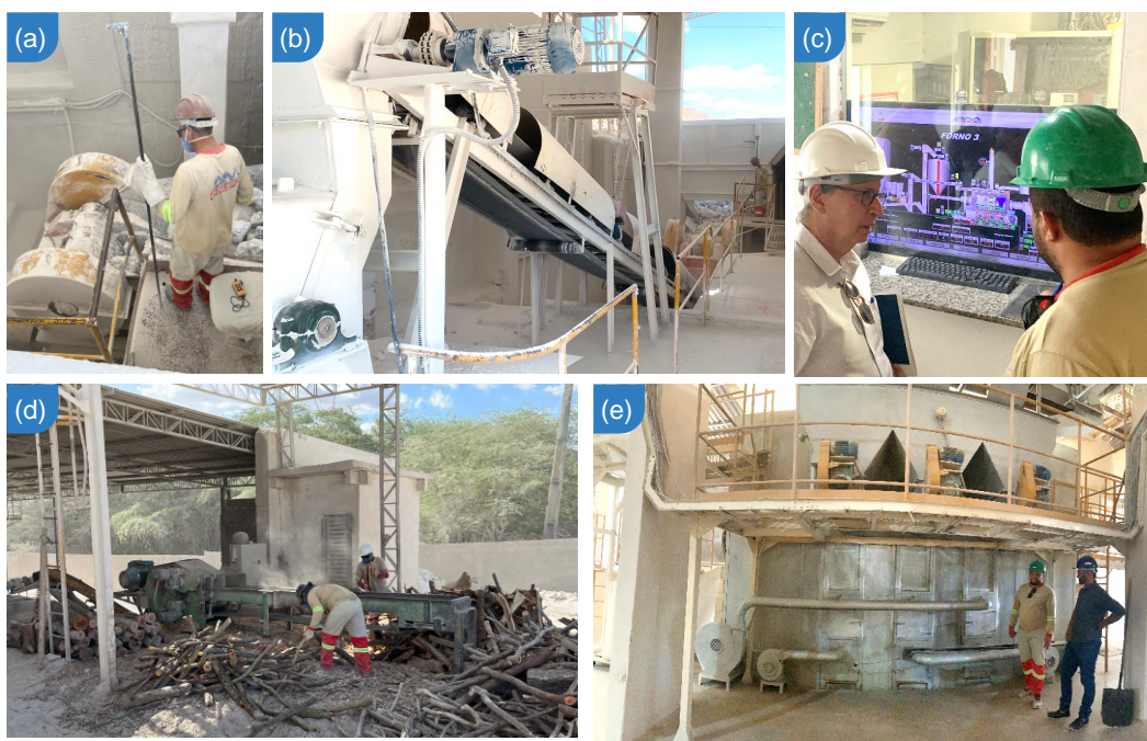
Figura 3. Equipamentos do processo de produção do gesso que podem ser financiados. (a) Britadeira; (b) Esteira; (c) Automação do processo de calcinação; (d) Picador; (e) Forno de calcinação “marmitta rotativa”.
