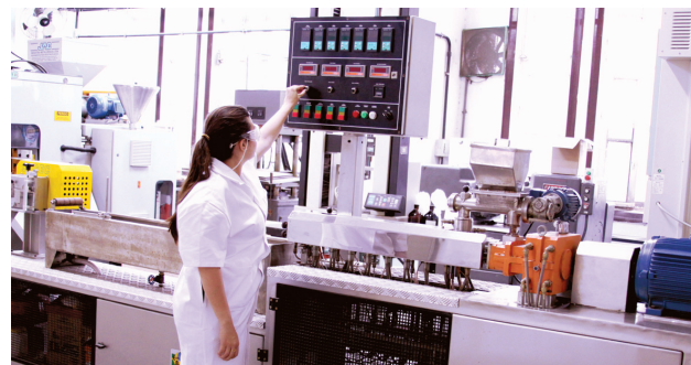
As emulsões contendo nanopartículas são injetadas com auxílio desta máquina extrusora do Laboratório de Tecnologia de Materiais Poliméricos do INT.
