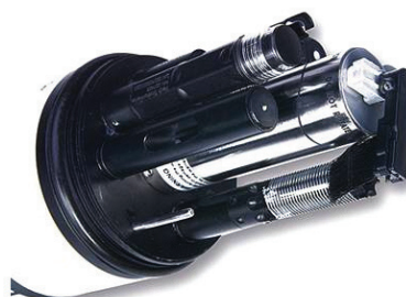
Eletrônica embarcada do comando do sistema de monitoramento Caipora – onde microcontroladores processam informações remotas – e, abaixo, sonda com conjunto de sensores, utilizada para captar os dados para o sistema.
