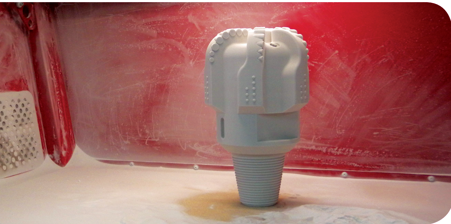
Matriz de peça para a indústria do petróleo gerada pela impressora 3D Voxel Jet (VX 800), no Laboratório de Modelos Tridimensionais do INT.
