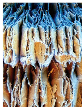
A mão mecânica impressa em 3D estará no estande do INT, na SBPC. Ao lado, detalhes da vermiculita (material argiloso usado como isolante térmico e acústico), revelados pela microscopia eletrônica.
