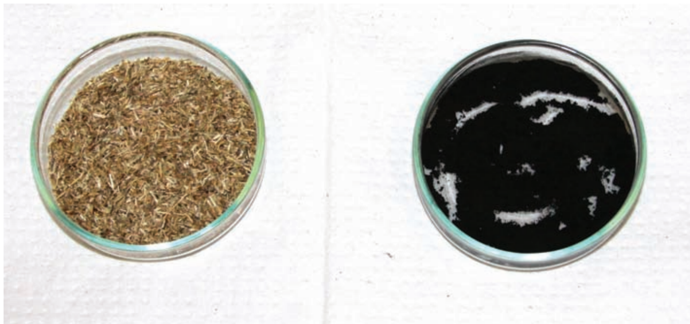
A biomassa de palha de cana-de-açúcar, antes e depois do processo de transformação em carvão ativado.
