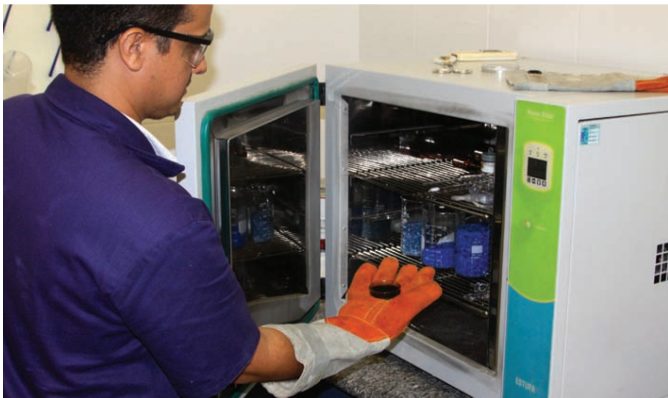
O carvão ativado é levado para secagem em uma estufa, de onde é retirado para suas aplicações.
