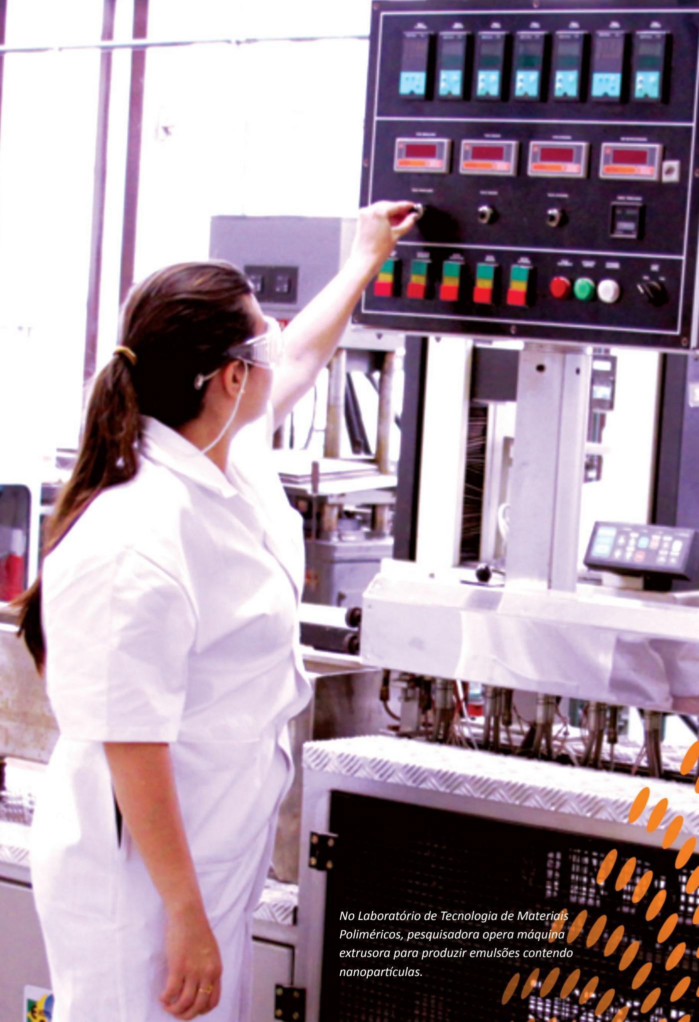
*No Laboratório de Tecnologia de Materiais Poliméricos, pesquisadora opera máquina extrusora para produzir emulsões contendo nanopartículas.*
