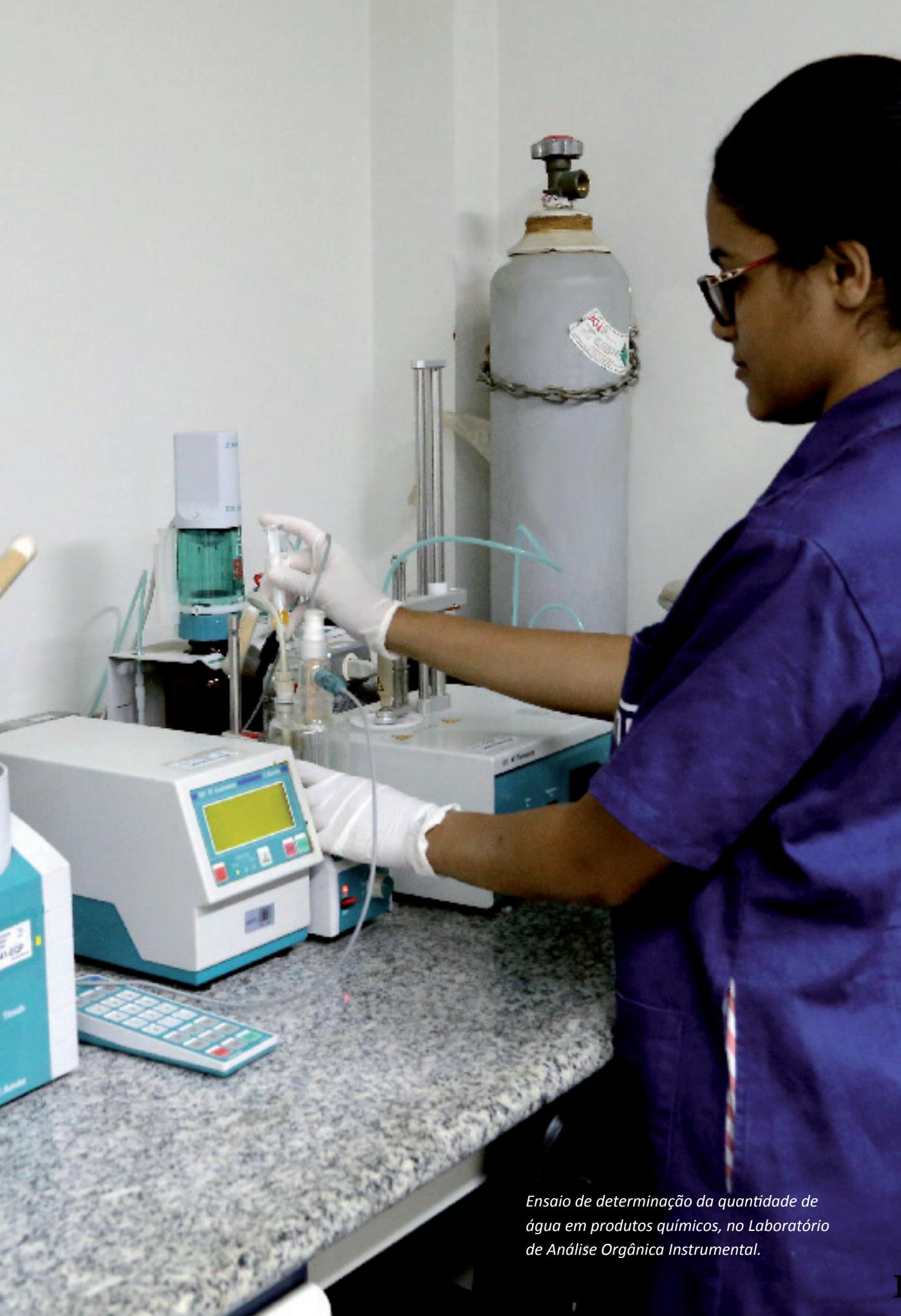
*Ensaio de determinação da quantidade de água em produtos químicos, no Laboratório de Análise Orgânica Instrumental.*
