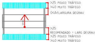
6 VISTA SUPERIOR ESCADAS
