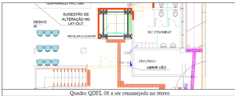
Quadro QDFL 06 a ser remanejado no térreo
