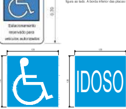
DETALHE 12 - SINALIZAÇÃO VAGAS RESERVADAS - ESC. 1/20
