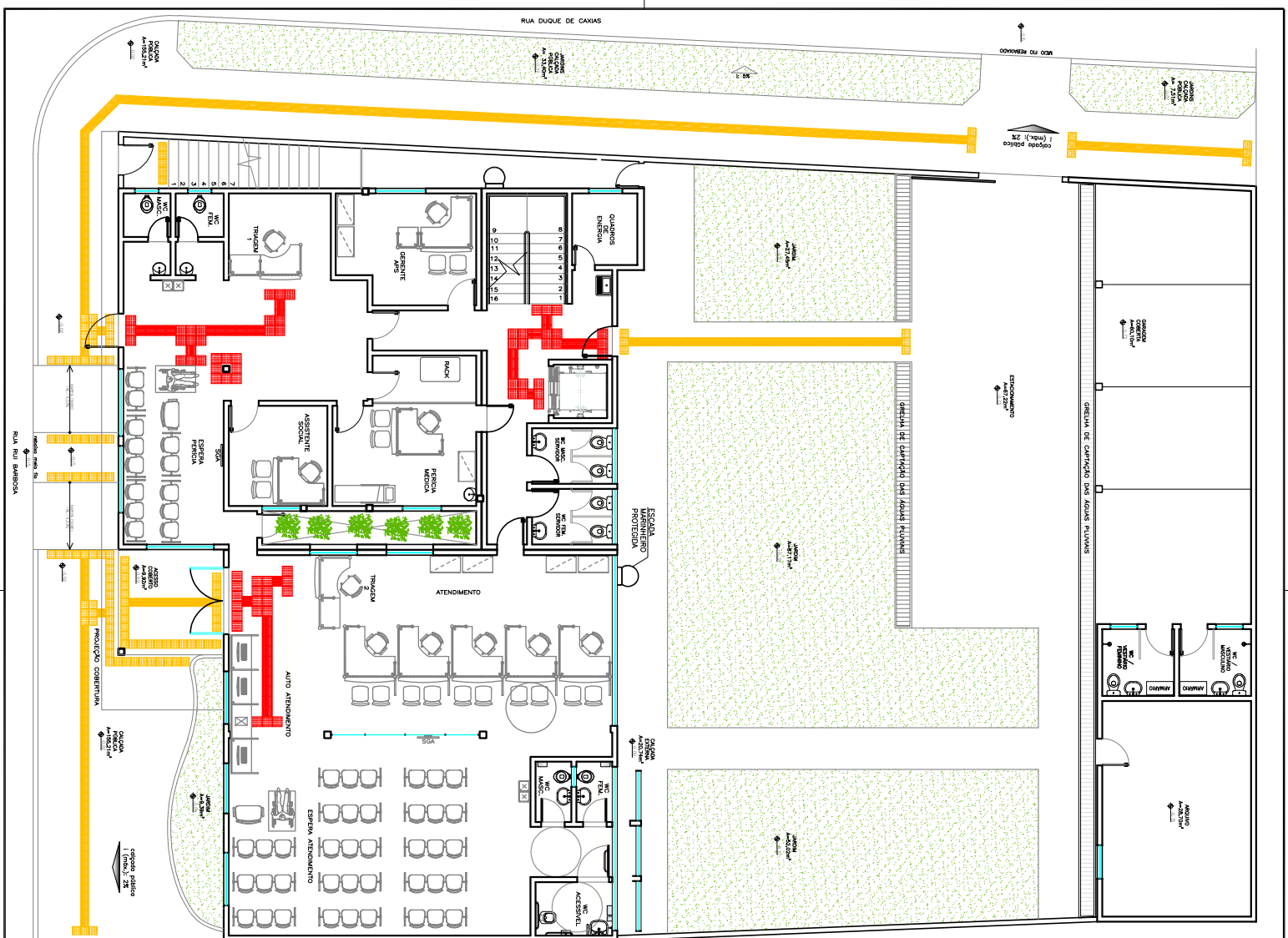
PLANTA BAIXA PAV. TERREO - PISO TÁTIL ESC.: 1/75
