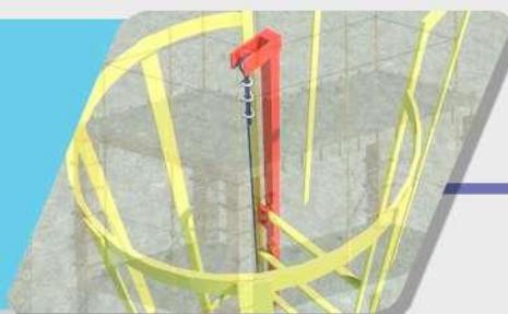
A construção civil apresenta um dos maiores índices de acidentes por queda em altura. A etapa de concretagem é uma das atividades que apresenta maior risco. A RF Engenharia projeta, fabrica, fornece e aluga sistema de linha de vida para concretagem.
