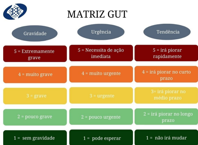
Figura 11. Matriz GUT – Gravidade, Urgência, Tendência
