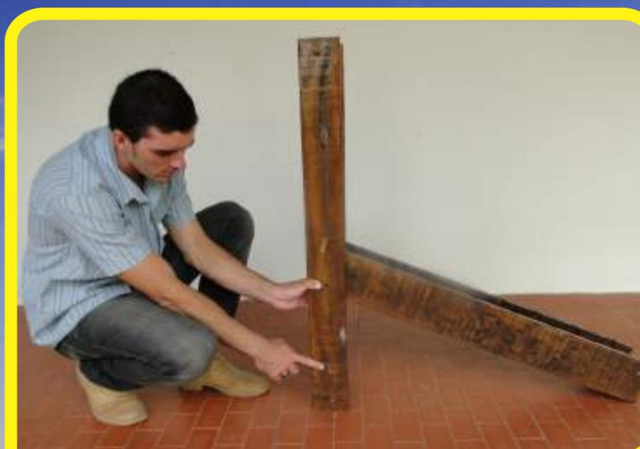
As pernas têm um furo a cada 10 cm nos quais pode se ajustar a altura da calha da rampa. Nesta foto, pode-se ver como se ajusta a 10, 20, 30 e por último 40 cm. Como a calha mede 100 cm, pode-se decidir que, em último caso, a rampa pode ter 40 cm de altura por 100 cm de comprimento. Ou seja, a calha tem um declive de 40 por 100 cm. ( Quarenta por cento de inclinação)
