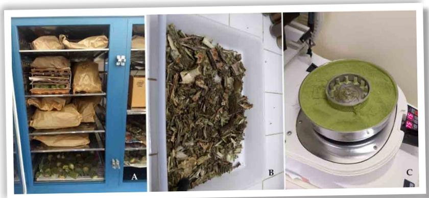
**Figura 11:** A. Secagem de material vegetal em estufa elétrica; B. Material seco em fragmentos grandes; C. Material moído, em pó.
