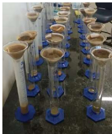
Beneficiamento de amostras de solo - terra fina seca ao ar + peneira 2,0mm; análises e quantificação dos parâmetros químicos do solo de interesse para a pesquisa.
