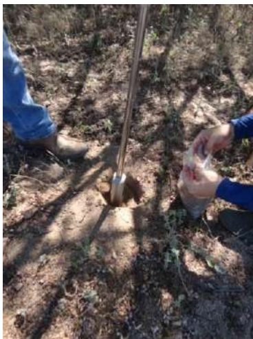
Tradagem e coleta de amostras de solos (0-30cm) em área de produção familiar com reuso agrícola.
