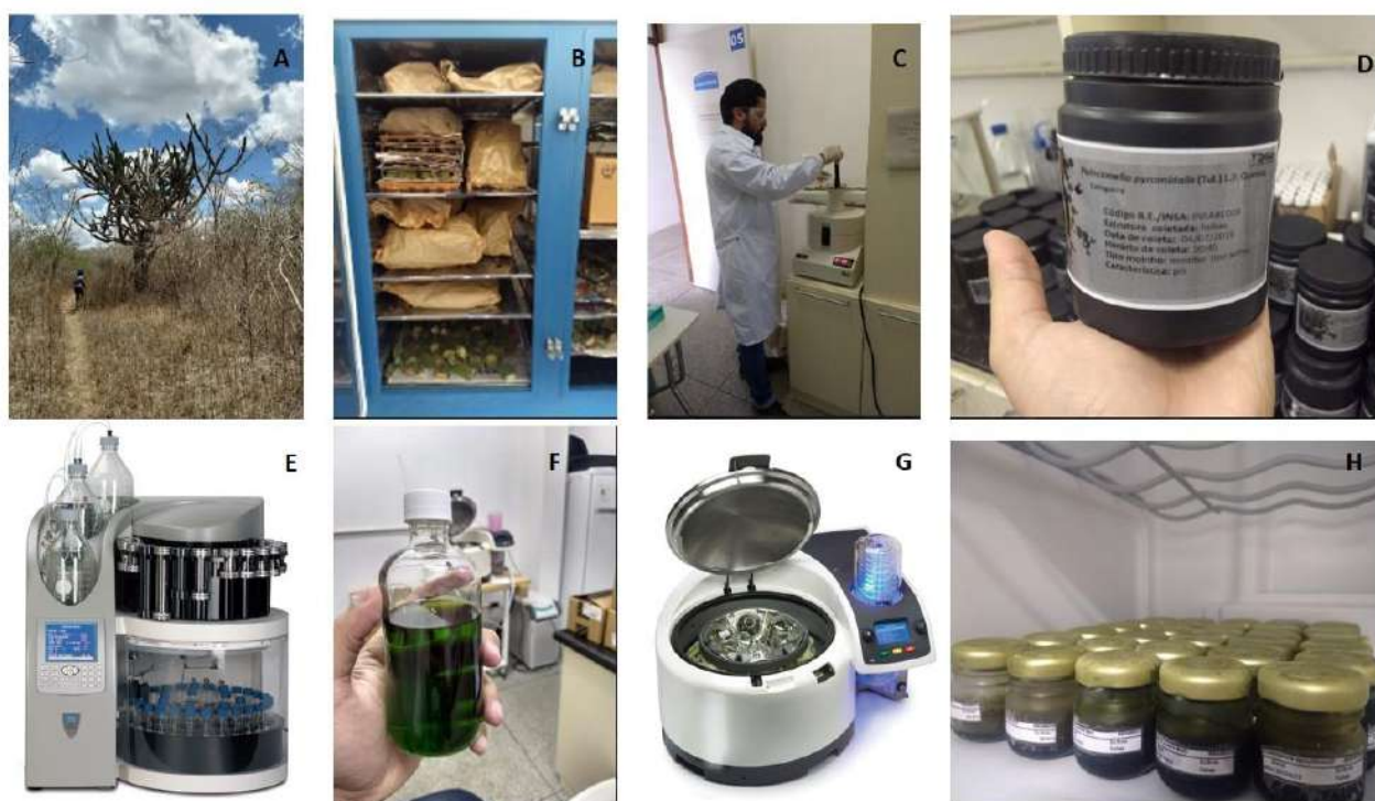
Etapas para a produção e padronização de extratos vegetais no INSA. A) Coleta do material vegetal; B) Secagem a 45° C; C) Processamento; D) Material processado e armazenado; E) Extração no ASE a 40° C; F) Material extraído com solvente de interesse; G) Concentração do extrato no evaporador ROCKET a 40° C; H) Extrato armazenado a -20° C.
