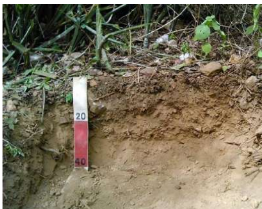
Perfil de Neossolo Litólico Eutrófico típico, textura média, A moderado, fase caatinga hiperxerófila, relevo suave ondulado a ondulado. Estação Experimental do INSA. Campina Grande, PB
