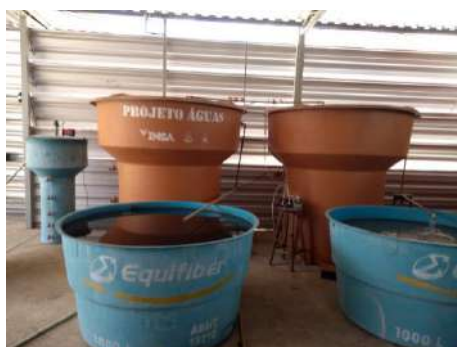
Foto dos Reatores UASB (a) recebe esgoto municipal; (b) recebe esgoto condinial.
