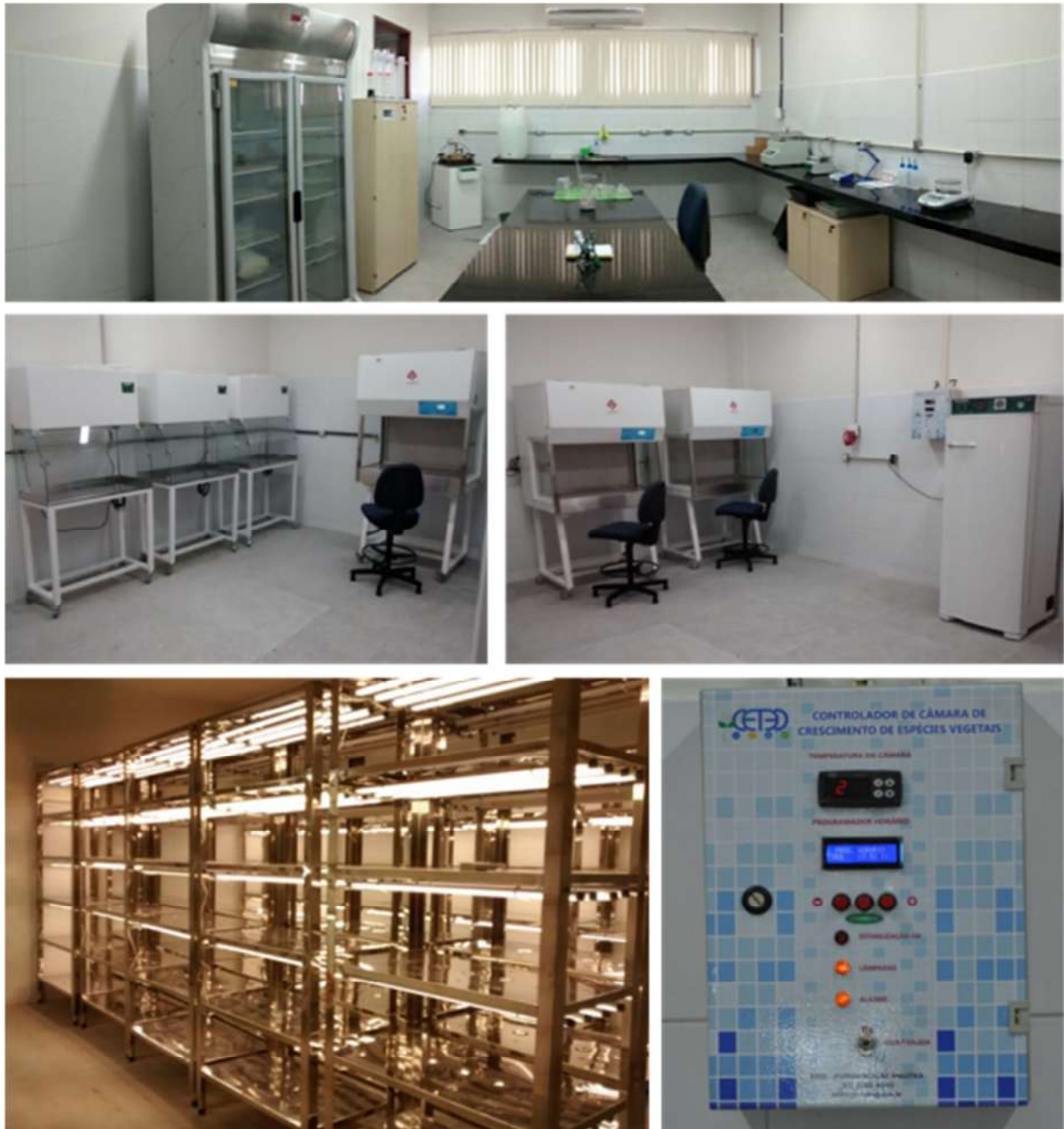
Figura 5. Instalações do Laboratório de Cultura de Tecidos de Plantas, no prédio Miguel Arraes da Estação Experimental do INSA. Sala de preparo de meio de cultura e recebimento de material; Sala de inoculação, com câmaras de fluxo laminar e incubadora com controle de fotoperíodo; Sala de crescimento com lâmpadas de LED e detalhe do controlador do fotoperíodo.
