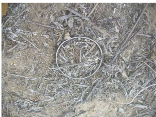
Determinação da mesofauna por meio de coleta de solo e serrapilheira com anel de aço inox
