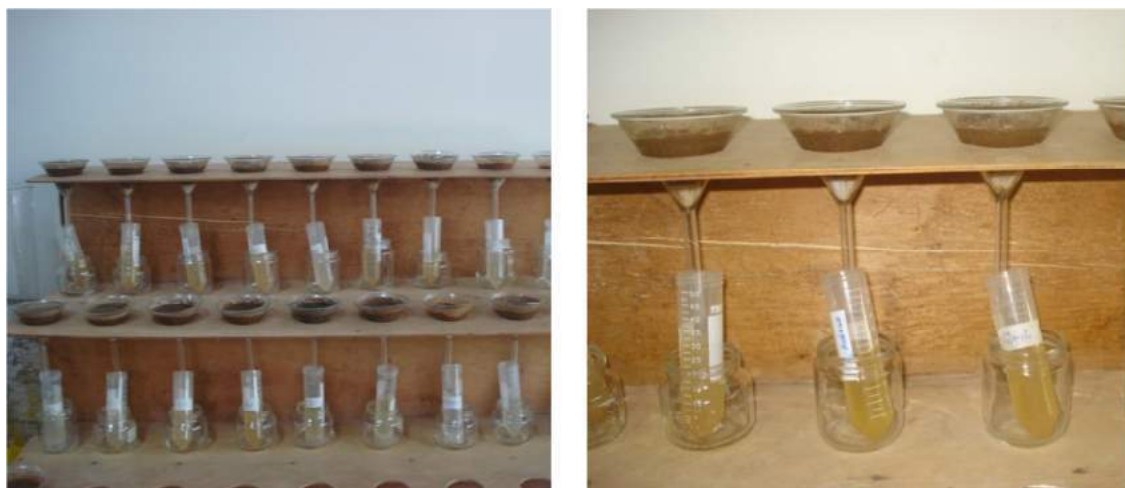
Figura 5. Método utilizado para obtenção da Umidade do Solo.
