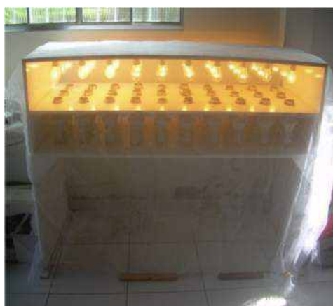
Bateria para captura da mesofauna, pelo método de Berleusse-Tullgren
