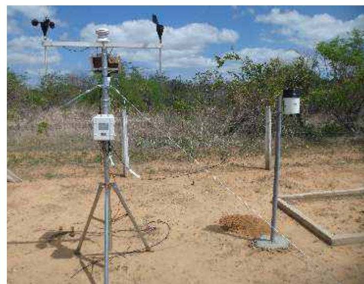
Torre Micrometeorológica instalada na área desertificada no estado da Paraíba.
