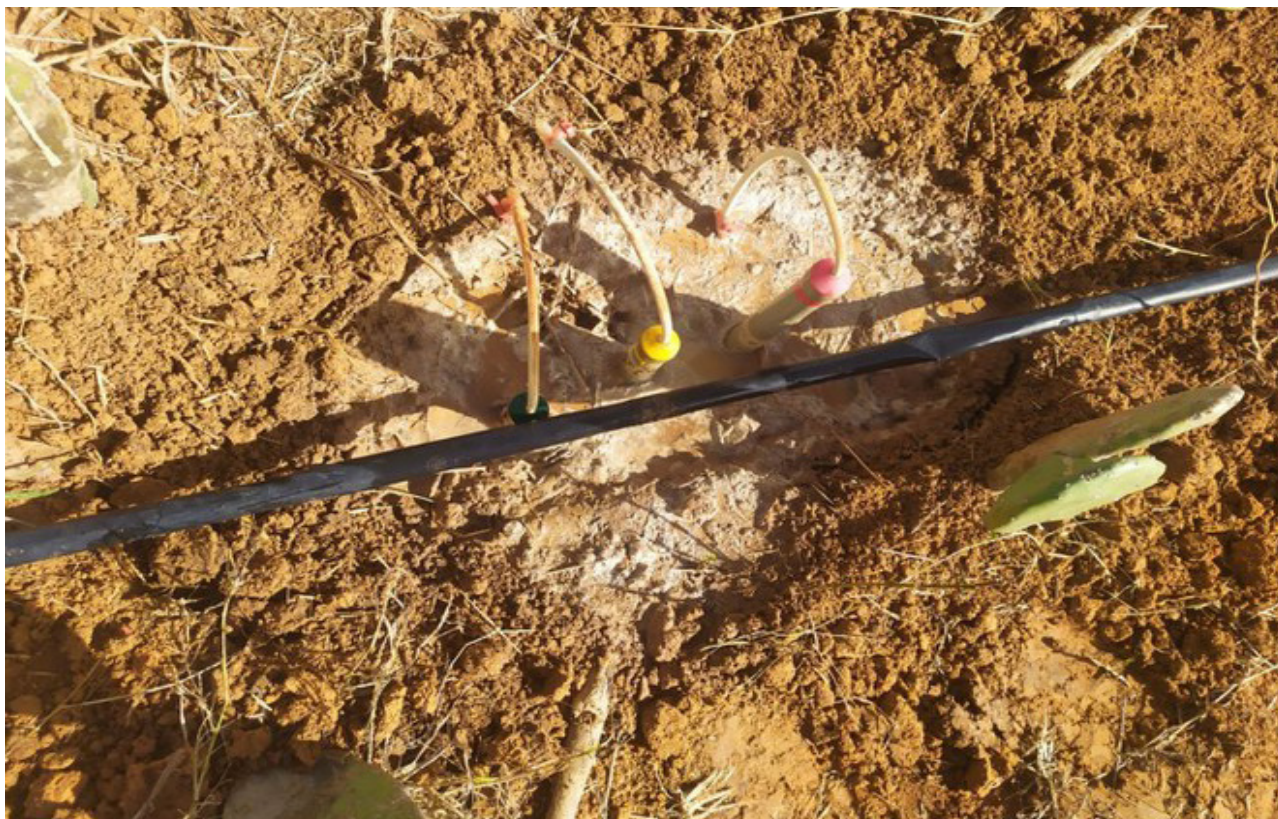
Pesquisadores examinam os Extratores de Solução do Solo para obtenção de dados sobre a salinidade do solo - Foto: Pablo da Silva Santos
