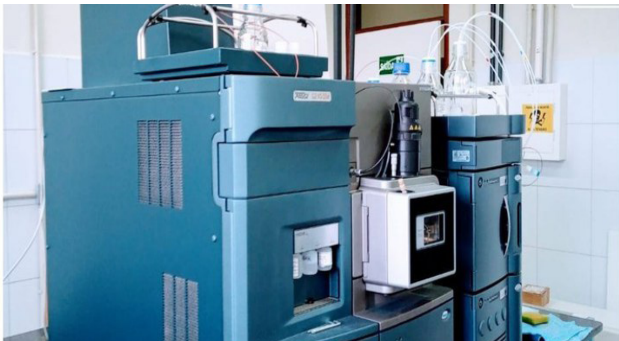
Espectrômetro de massa de alta resolução no Laboratório de Bioprospecção do INSA - Foto: Daniel Araújo
