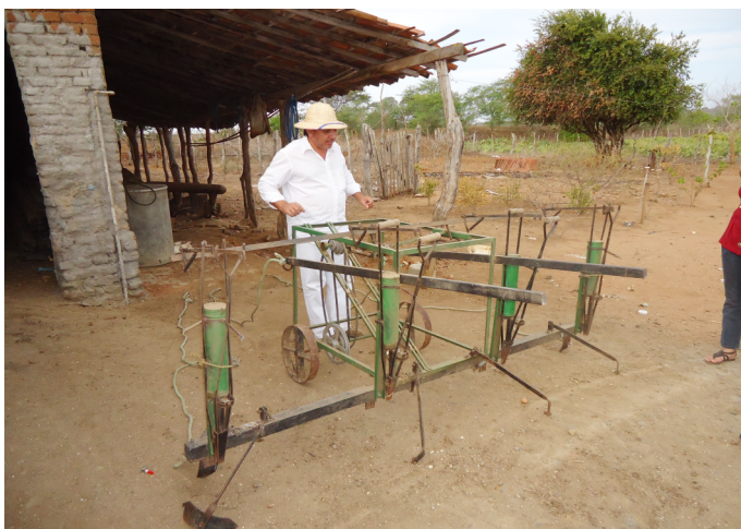
Agricultor desenvolve sistema com 4 plantadeiras simultâneas
