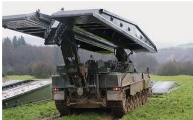
ponte móvel em veículo militar E01D 15/12
