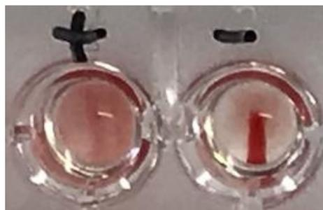
Os autores propõem um sensor magnético (MRSw) baseado em pontos quânticos de grafeno magnético conjugado com anticorpo SARS-CoV-2 (GQDs) que reconhece especificamente o SARS-CoV-2. A sonda de MRSw pode ser misturada diretamente com a amostra de teste em um frasco totalmente selado sem pré-tratamento de amostra, o que reduz em grande parte
