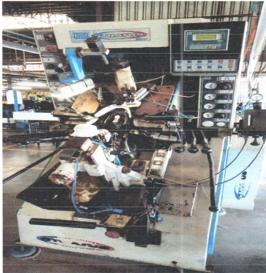
Foto 14 – Aplicação de adesivo no cabedal e no solado.
