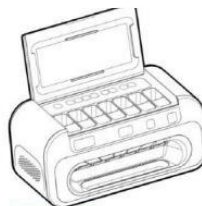
Exemplo de representação com uso de linhas contínuas com variação de espessura (BR302018055094)
