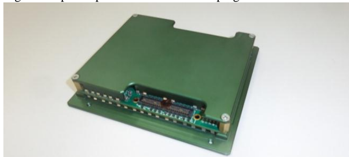
Figura 13: protótipo do subsistema de criptografia do RDS
