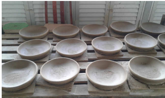
Figura 04: Primeira secagem (Fonte: acervo próprio)
