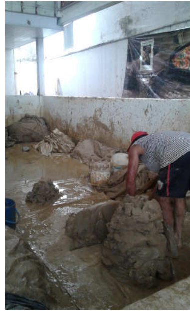
Figura 02: Amaciamento do barro (Fonte: acervo próprio)
