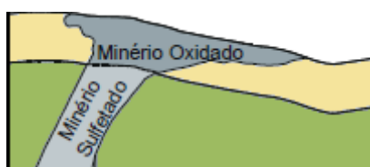
Figura 4.1 – Ilustração da localização dos minérios sulfetados e oxidados.
