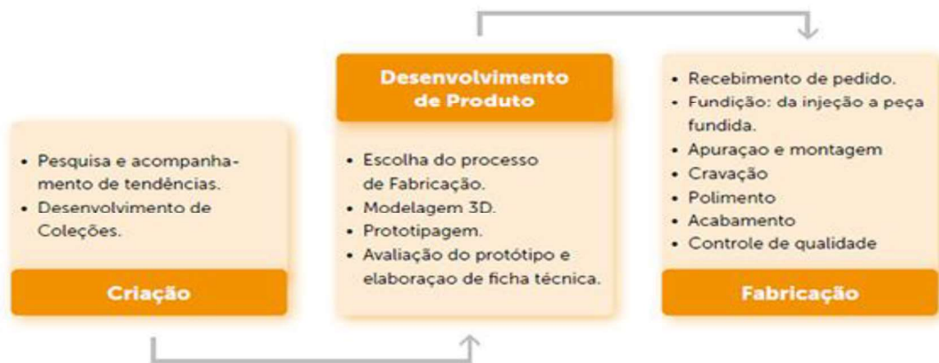
Figura 16: Sequencia de produção de uma joia industrial (larga escala)
