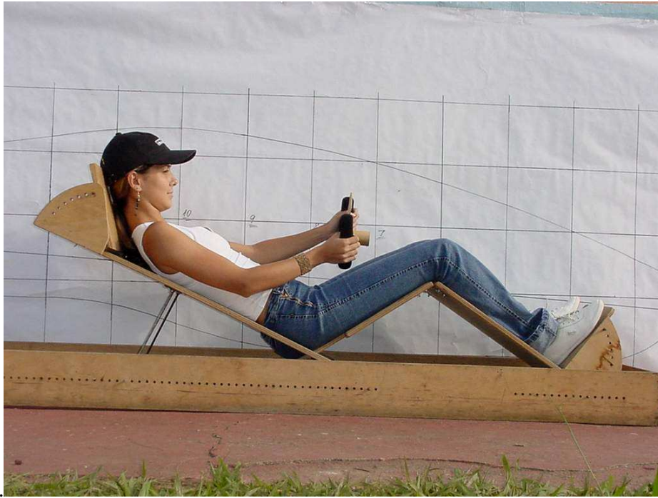
FIG.34. Estudo ergonômico para produção do banco do Sabiá 4
