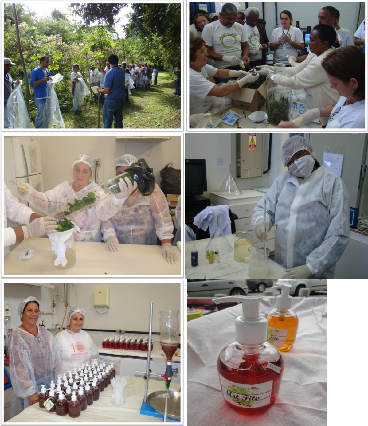
Figura 16. Etapas da produção de sabonete líquido: a) coleta, b) seleção, c) produção de extrato, d) sabonete, e) envase, f) produto pronto para venda. Fonte: Acervo Profito
