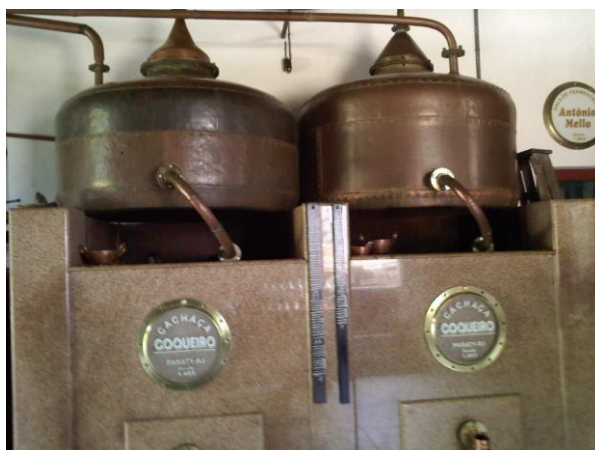
Figura 08: Instalações da Destilaria Engenho D'Água, produtora da marca Coqueiro, alambiques. Fonte: Acervo pessoal.
