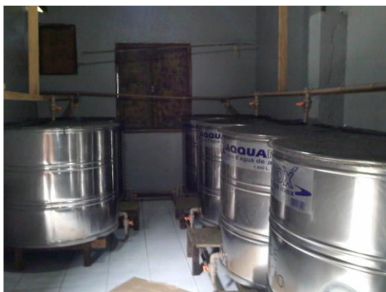
Figura 20: Instalações do Engenho D`Ouro, dornas de fermentação. Fonte: Acervo pessoal.
