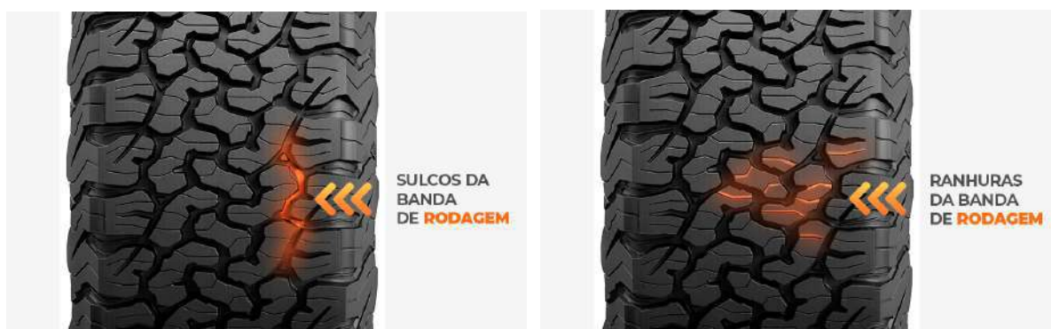
Figura 95 - Sulcos e ranhuras presentes em bandas de rodagem. Fonte: https://tinyurl.com/sulcos-ranhuras . Acesso em: 23 jul. 2025.
