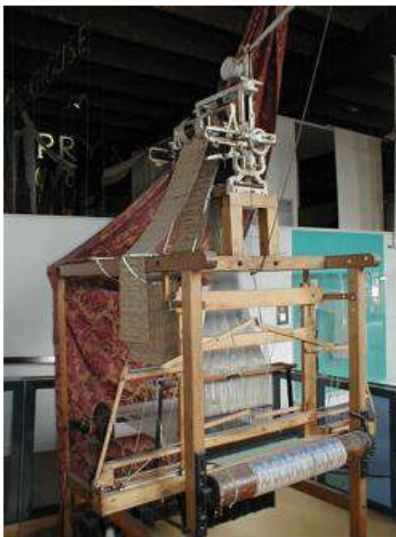
Figura 3 - À esq.: tear de Joseph Marie Jacquard (1801). À dir.: a Water Frame de Richard Arkwright (1767).
