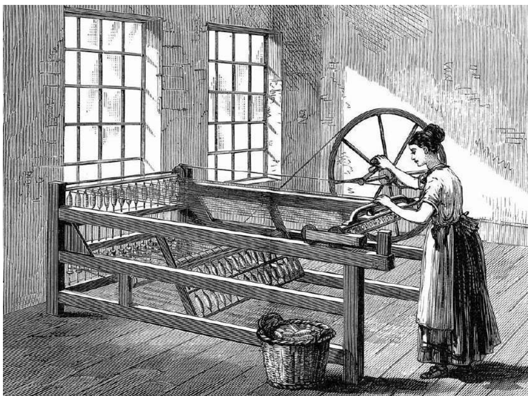
Figura 2 - Spinning Jenny , a máquina de fiar de James Hargreaves (1764).
