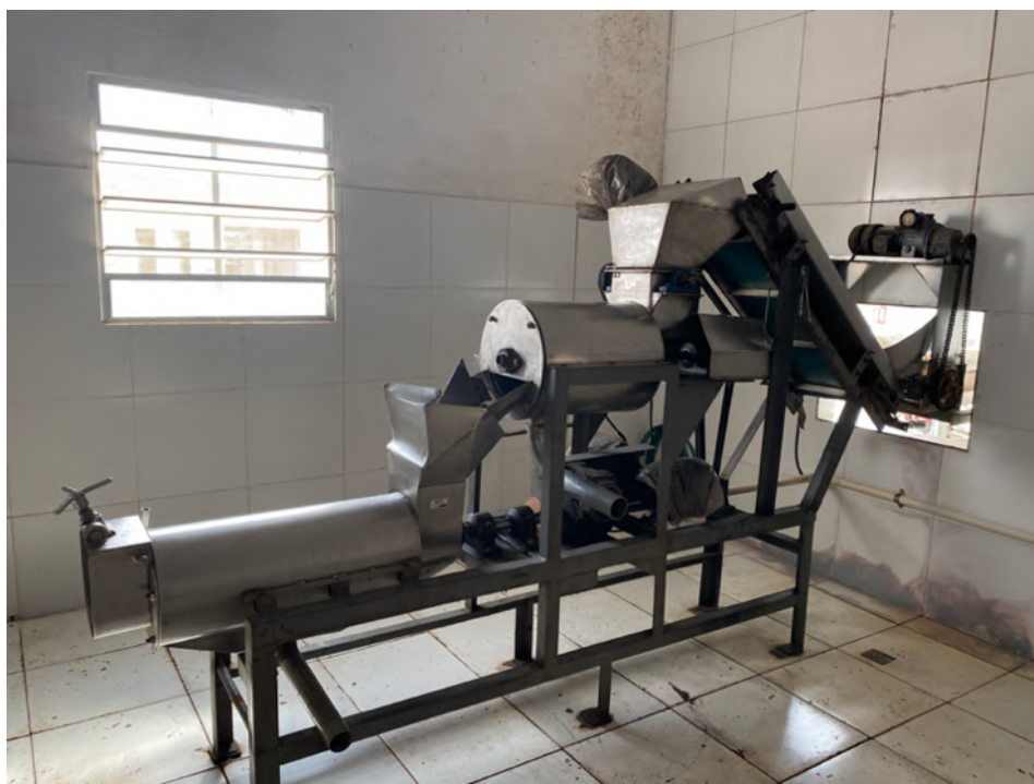
Figura 18 – Prensa tipo expeller em uma fábrica de cajuína
