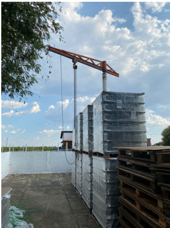
Figura 31- Empilhadeira estilo portuária adaptada por um produtor de cajuína Fonte: Arquivo pessoal da pesquisadora.
