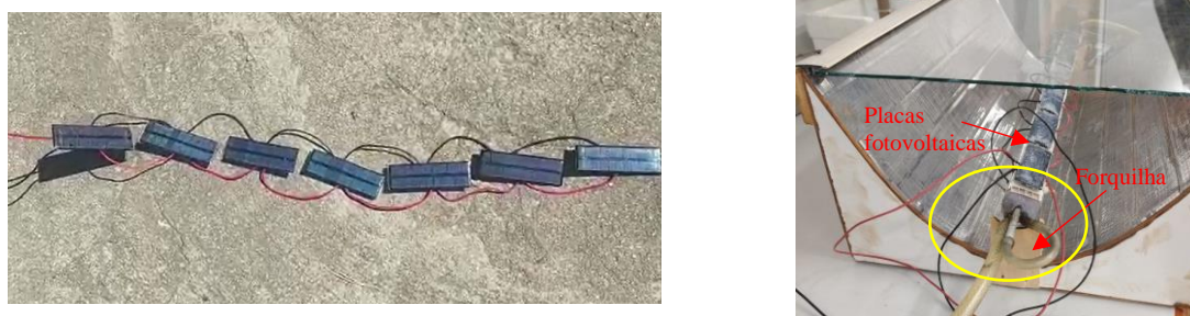
Figura AP.B.1 – Fotos das placas solares ligadas em série antes da instalação no ponto focal do coletor termossolar e a lâmpada focal apoiada em forquilha
