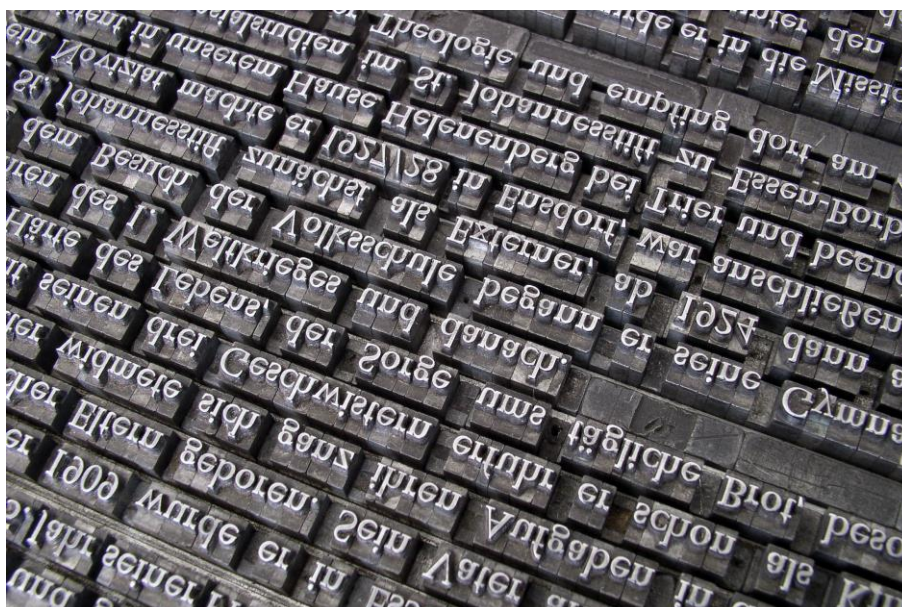
Figura 5 – Tipos metálicos em processo de composição. Fonte: Heidelberg (2019).
