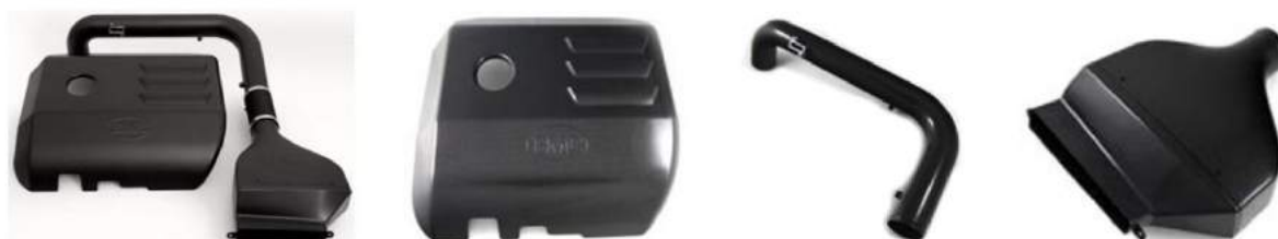
Figura 37 – Produto montado (esq.), acompanhado de suas partes constitutivas.
