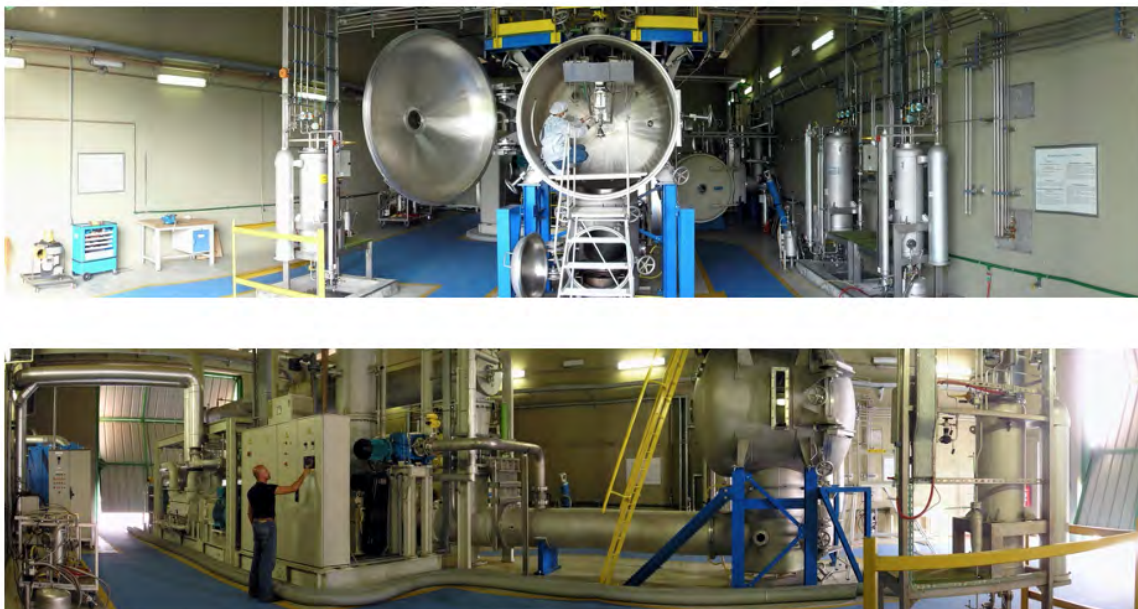
Figura 1.12 - Fotos da câmara de vácuo principal do Banco de Testes com Simulação de Altitude.
