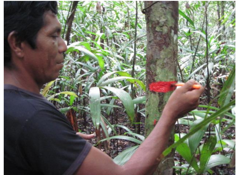
Pintando altura de medição do diâmetro com tinta
