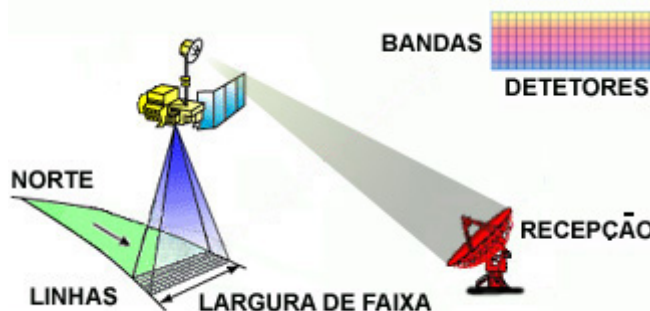
Figura 14. Varredura de um imageador orbital multibandas.
