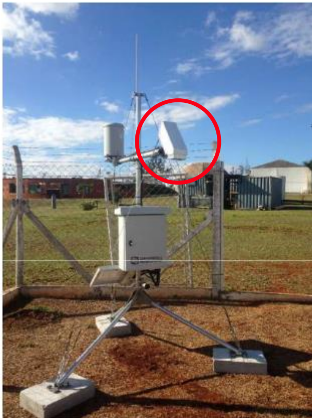
Figura 3.4 – Sensor EFM (CS110) instalado pelo projeto SOS-Chuva em Campinas. Círculo vermelho mostra o sensor EFM instalado a estação meteorológica.
