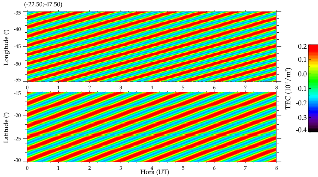
Figura 3.9 - Keograma zonal e meridional para uma onda com comprimento de onda de 200 km, período de 60 minutos e direção de propagação para Nordeste.
