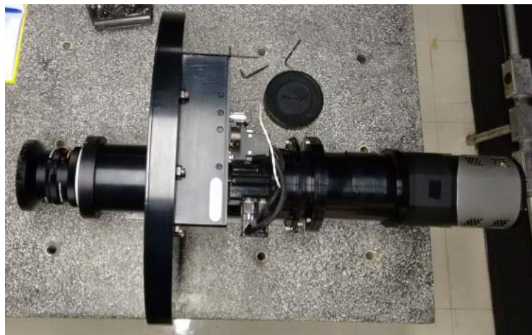
Figura 3.5 - Fotômetro imageador all-sky.
