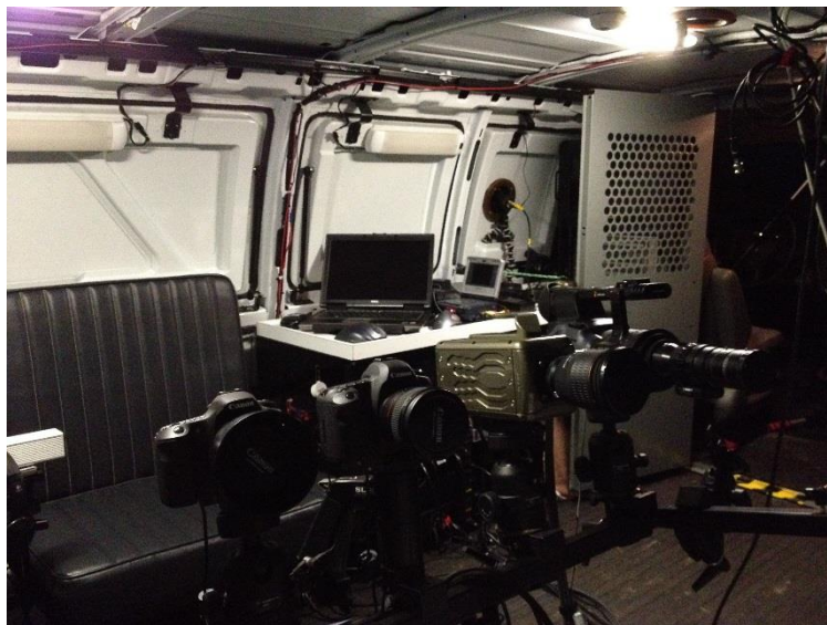
Figura 3.16 Estação móvel VAN: Banco traseiro para um operador. As câmeras faceiam a janela lateral do veículo.
