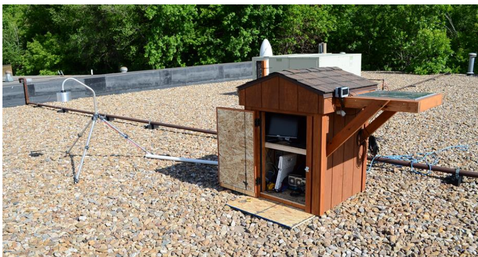
Figura 3.19 Base fixa 2: Sensores de campo elétrico: rápido (um ganho) e ambiente.
