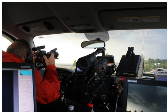
Figura 3.17 Estação móvel Truck : 2 assentos (um para motorista e outro para o operador), câmeras na janela frontal, computadores e telas para o operador
