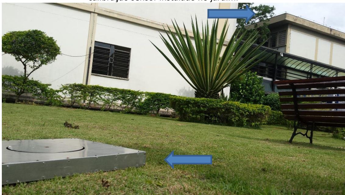
Figura A1 : Calibração USP – Sensores no topo do Prédio de 2 andares e para calibração sensor instalado no jardim.
