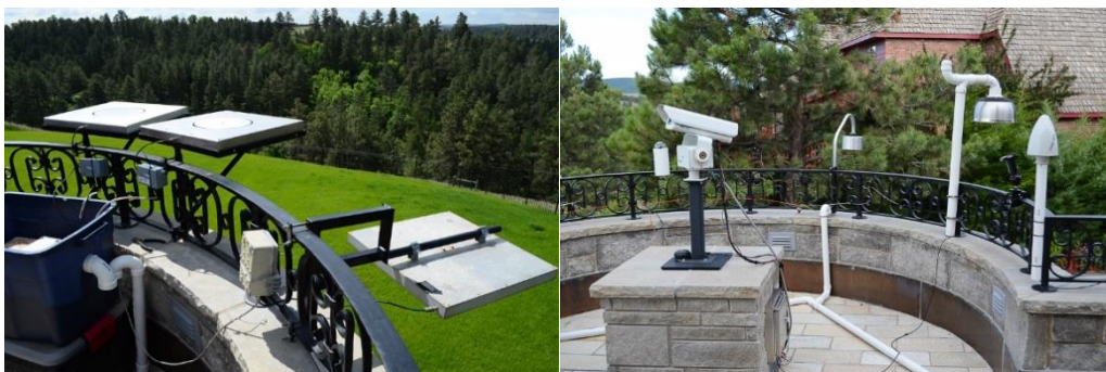
Figura 3.18 - Base fixa 1: Sensores de campo elétrico: rápido (dois ganhos) e ambiente.
